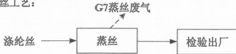
图 3-8 蒸丝生产工艺及产污流程图
